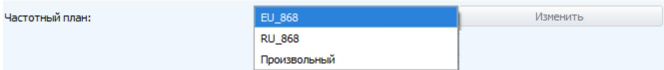
Модем поддерживает следующие частотные планы:
