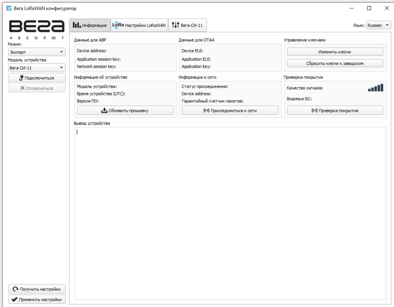
Меню слева позволяет переключаться между режимами работы программы «Простой» и «Эксперт», выбирать модель устройства, осуществлять подключение к устройству или отключаться от него, получать и применять настройки.
