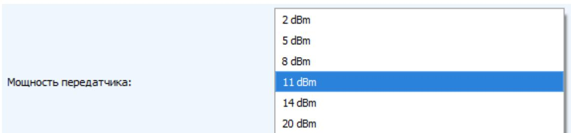
**Скорость передачи** (не отображается в режиме «Простой») – регулируется скорость передачи, на которой устройство будет передавать пакеты в сеть LoRaWAN. Данная скорость может быть изменена сетью, если включен алгоритм ADR.
