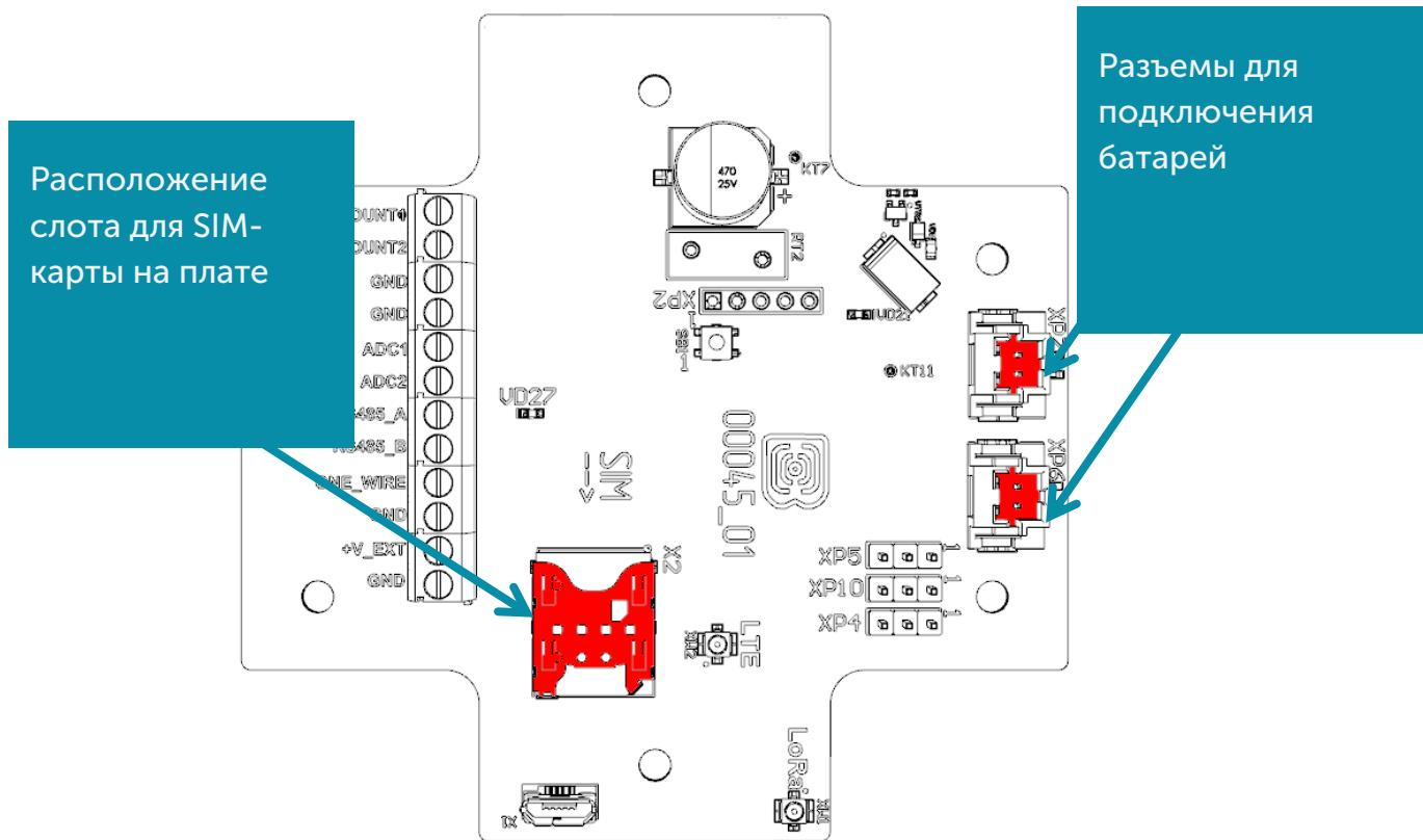
Модем NB-15 может питаться как от внешнего источника питания, так и от встроенной батареи. Для работы от встроенной батареи необходимо подключить разъём батареи к одному из разъёмов питания на плате с маркировкой XP7 либо XP6. В случае работы устройства от двух батарей следует использовать оба разъёма.
