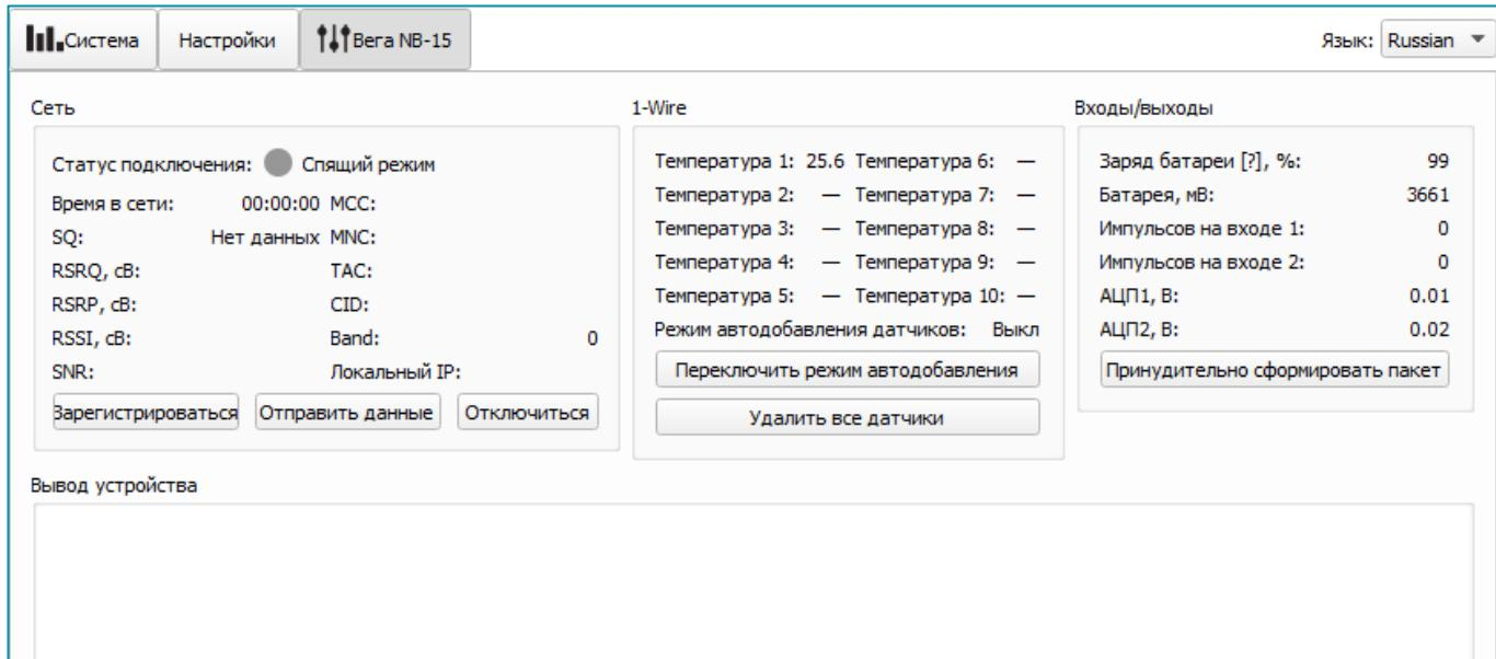
**Сеть** – отображает текущие параметры подключения, а также позволяет управлять им. Кнопки в данном блоке повторяют логику кнопки INIT на плате.
