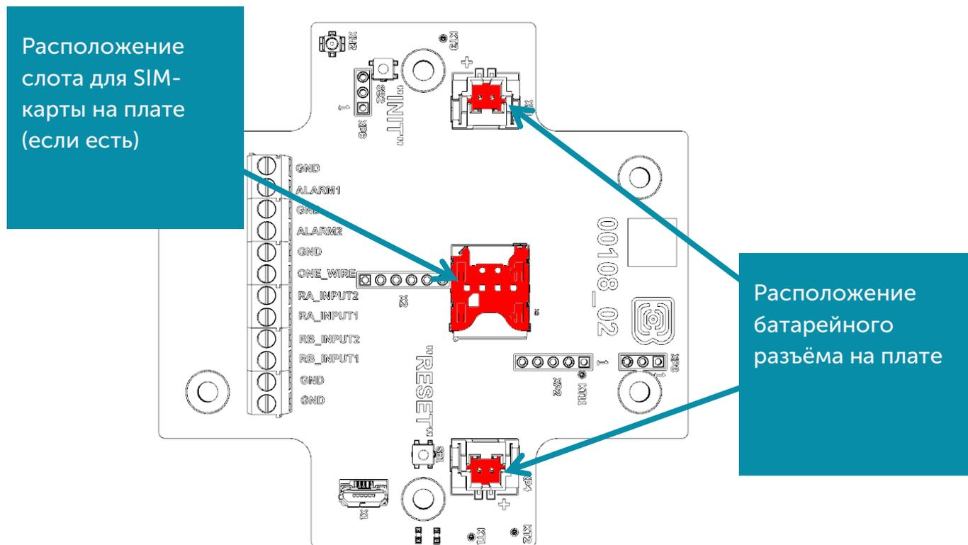
Модем NB-14 работает от одной или двух батарей в комплекте. На плате расположены равнозначные разъемы. После подключения батареи к одному из разъемов устройство загружается и уходит в сон до выхода на связь по расписанию.
