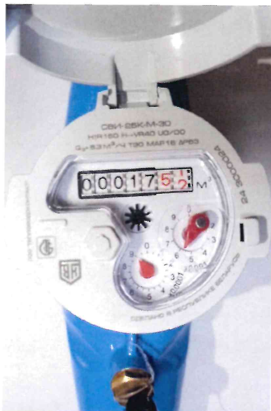
Рисунок 1.2 – Фотографии общего вида и маркировки счетчиков воды крыльчатых «СВ» с номинальным диаметром DN25, DN32 и DN40
