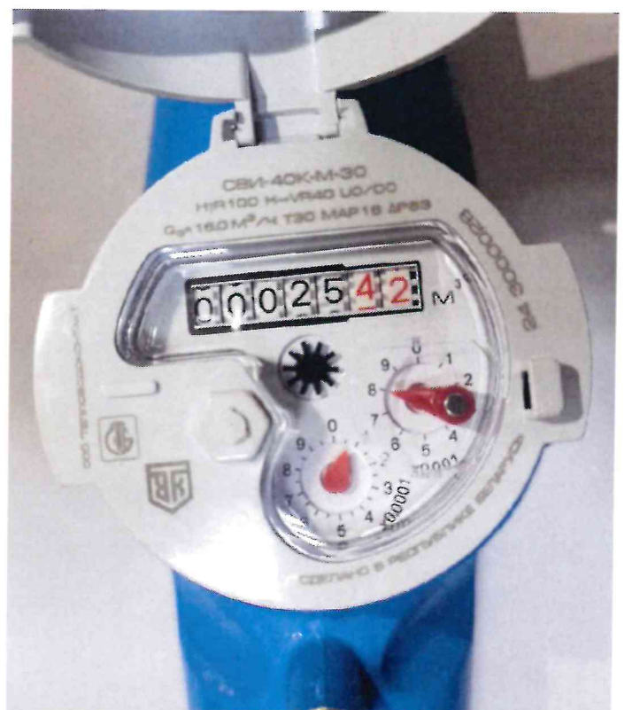
Рисунок 1.2 – Фотографии общего вида и маркировки счетчиков воды крыльчатых «СВ» с номинальным диаметром DN25, DN32 и DN40
