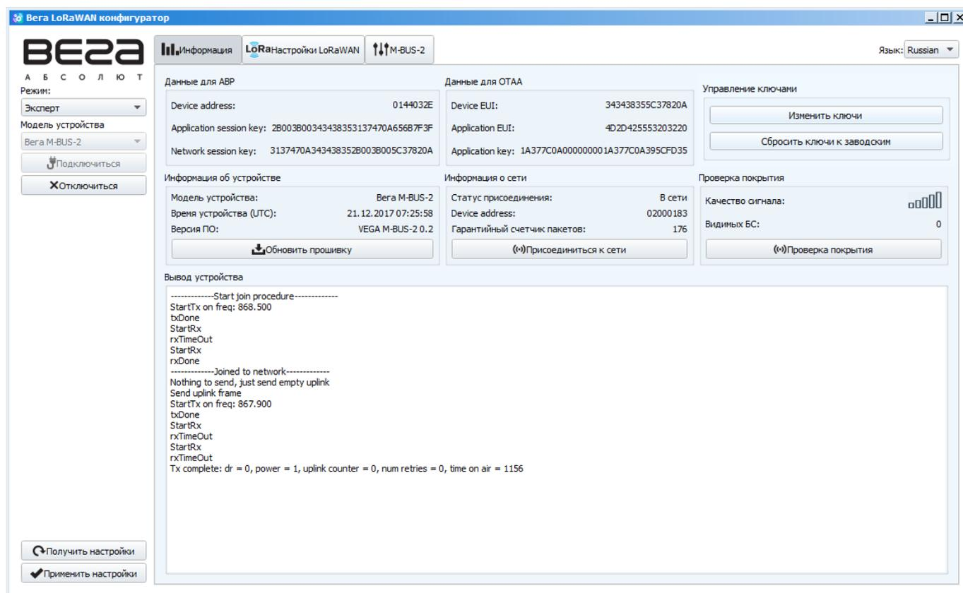
Для считывания настроек с устройства нужно нажать кнопку «Получить настройки», до этого момента в программе будут отображаться настройки по умолчанию или с последнего подключенного устройства.
