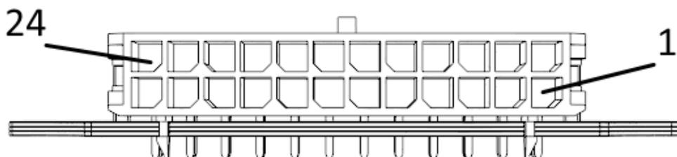
Конвертер имеет 12 пар контактов в колодке, которые являются M-BUS интерфейсами. Сам конвертер позволяет подключить до 10 устройств с интерфейсом M-BUS. Для этого могут быть выбраны любые 10 пар из 12-ти. При этом контакты 1-12 являются M-BUS- (нижний ряд), а контакты 13-24 M-BUS+ (верхний ряд).
