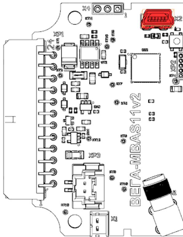
Перед первым подключением устройства к компьютеру необходимо установить драйвер для COM-порта **stsw-stm32102**, который можно скачать на сайте [iotvega.com](http://iotvega.com). После запуска исполняемого файла **VCP\_V1.4.0\_Setup.exe** появится окно установщика:
